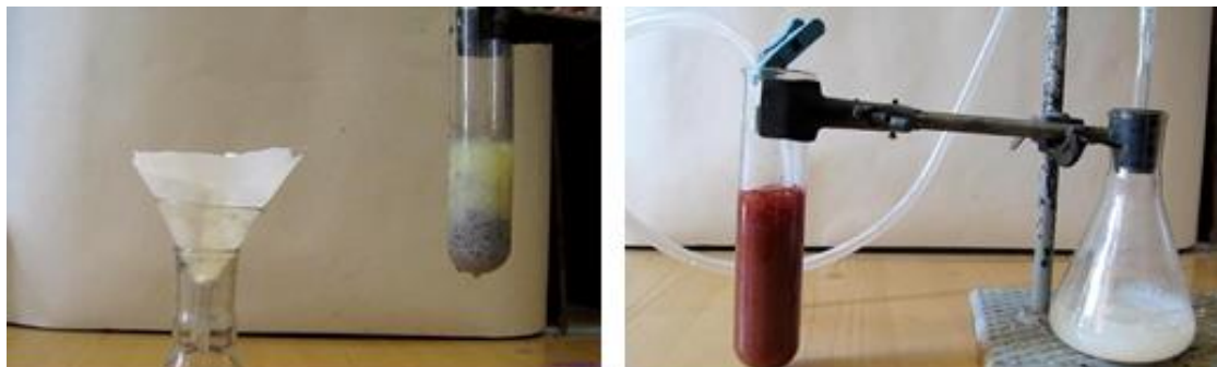
Образование ацетиленидов серебра и меди при пропускании ацетилена через: 1) аммиачный раствор оксида серебра(I) и 2) аммиачный раствор хлорида меди(I)
